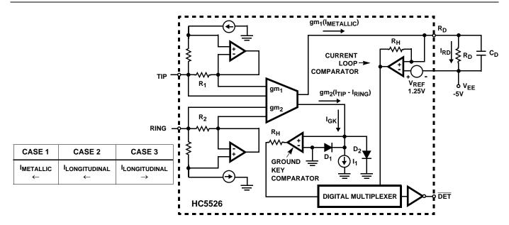
FIGURE 18. LOOP CURRENT AND GROUND KEY DETECTORS
