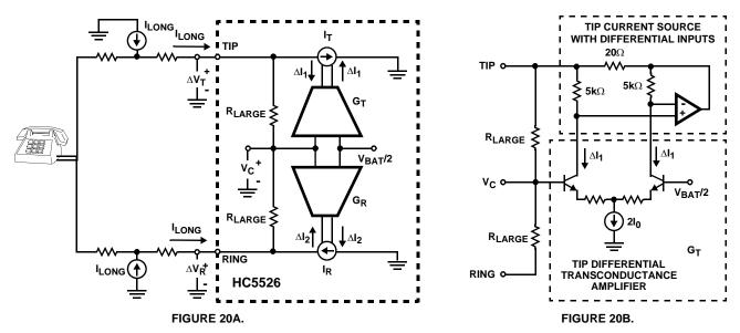
FIGURE 20. LONGITUDINAL IMPEDANCE NETWORK
