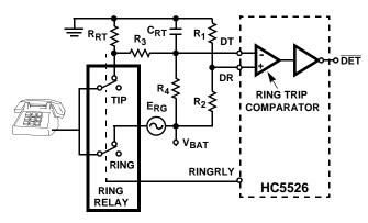
FIGURE 19. RING TRIP CIRCUIT FOR BATTERY BACKED RINGING
